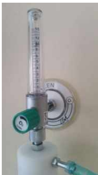
Rycina 11. Przepływomierz niskoprzepływowy pozwala na maksymalny przepływ tlenu do 15 L/min.
