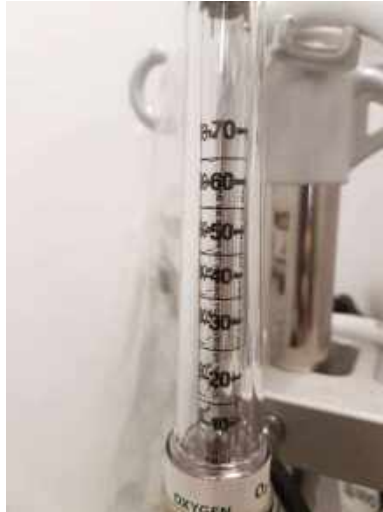
Rycina 12. Przepływomierz wysokoprzepływowo pozwalający na stosowanie przepływu tlenu do 70L/min.
